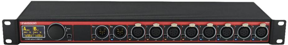
Die XPD-28 Splitter verteilen die DMX-Signale von zwei Eingängen verstärkt und aufbereitet auf acht Ausgänge. Damit kann die 32-Geräte-Grenze des DMX-Standards problemlos überwunden werden und das Erstellen von Stern-Topologien wird ermöglicht. Genauso kann der XPD-28 auch als Repeater eingesetzt werden, um grössere Distanzen zu überwinden.
